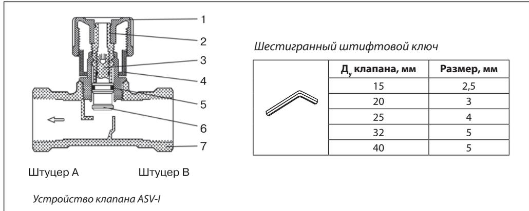
Запорно-балансировочный клапан ASV-I может применяться в следующих случаях: с его помощью можно перекрыть поток перемещаемой по трубопроводу среды, сбалансировать гидравлику трубопроводной сети путем изменения пропускной способности клапана за счет ограничения степени его открытия (величины подъема штока) и присоединить импульсную трубку от регуляторов ASV-PV (ASV-P).
