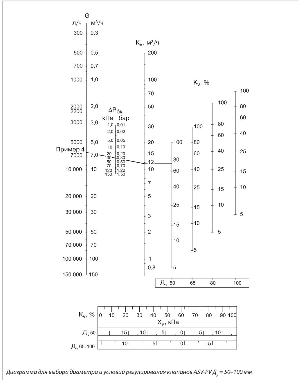
**Выбор диаметра и настройки клапанов ASV-I**
