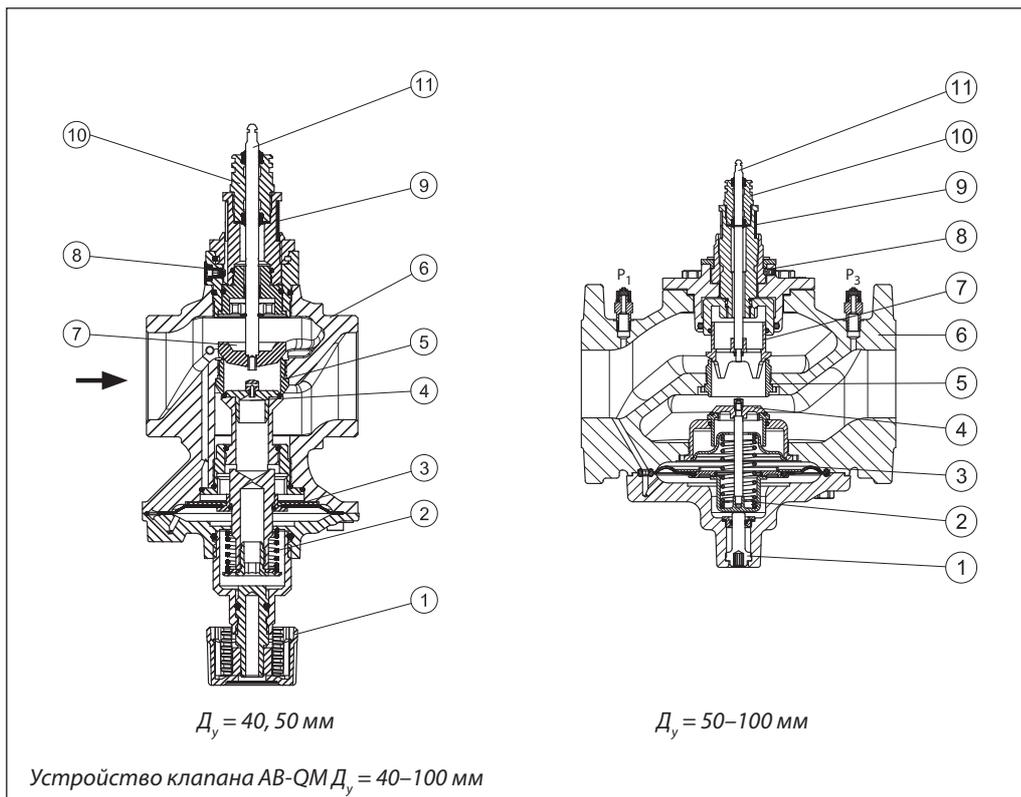
Устройство клапана АВ-QM
