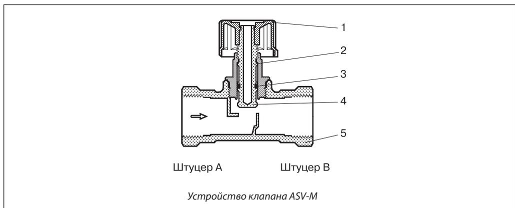
Клапан ASV-M не оснащен устройством настройки и может быть использован только в качестве запорной арматуры и для присоединения импульсной трубки к подающему трубопроводу системы.
