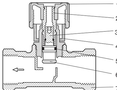
Устройство клапана USV-I
