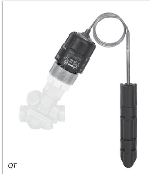
Термостатический элемент QT прямого действия предназначен для регулирования температуры обратного теплоносителя в однотрубных стояках систем водяного отопления зданий. Термостатический элемент QT применяется совместно с клапанами АВ-QM, выполняющими автоматическую балансировку и регулирование расхода.
