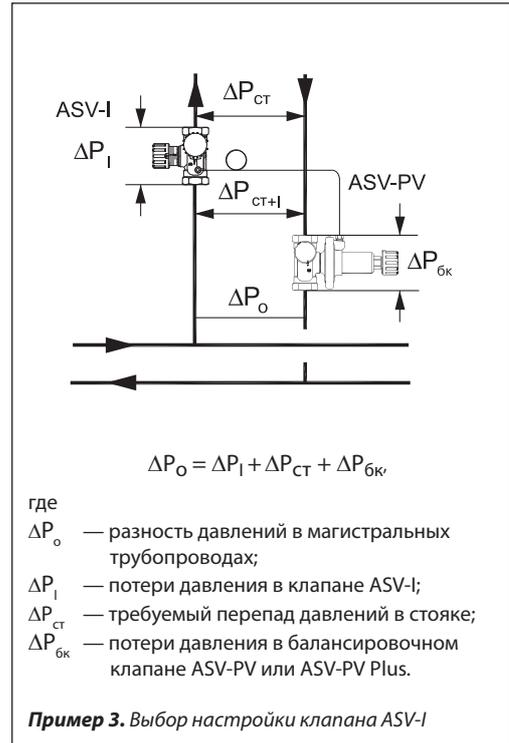
данные точки, на шкале  $K_v$  находим требуемое значение пропускной способности —  $3,6 \text{ м}^3/\text{ч}$ . Далее проводим горизонтальную линию до вертикальной шкалы настроек клапана —  $D_y = 25 \text{ мм}$ , где находим значение настройки.
