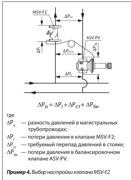
Для данного примера выбран клапан  $D_y = 50$  мм. Подбор клапанов можно также производить с помощью диаграммы на стр. 20.
