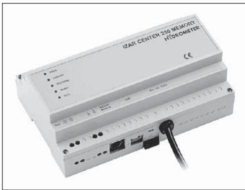
Концентратор Izar Center Memory – это преобразователь сигналов M-bus, выполняющий роль M-bus-мастера (ведущего) в сети M-bus. Прибор Izar Center Memory предназначен для считывания данных с M-Bus-устройств (теплосчетчиков, счетчиков воды, газа, электроэнергии и др.), объединенных в сеть M-bus и хранения данных в энергонезависимой памяти.
