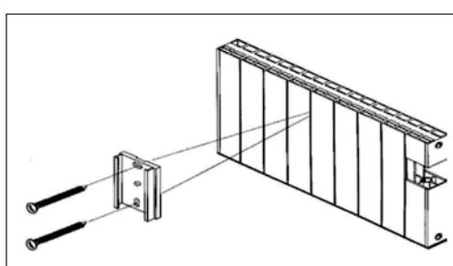
Монтаж на чугунные секционные радиаторы
