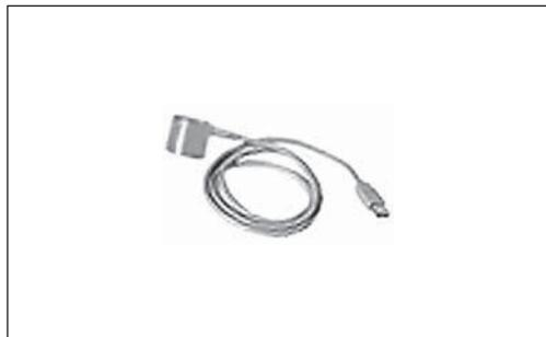
Адаптер АПС 78 служит для подключения переносного накопителя АДС 90 к приборам СПТ 943.1, оснащенным оптическим коммуникационным портом. Подключение накопителя АДС 90 с помощью адаптера АПС 78 к прибору через оптический порт не требует снятия пломб и перевода прибора в незащищенный режим хранения данных. Адаптер представляет собой преобразователь сигналов интерфейса RS 232C в оптические сигналы инфракрасного диапазона и обратно.
