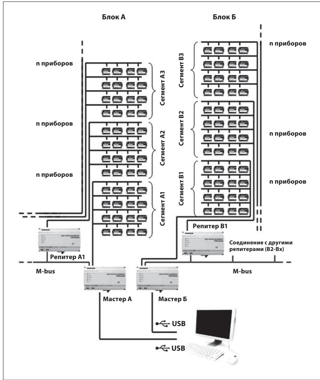
Пример построения системы диспетчеризации в двухсекционном доме на 1608 приборов учета, по 804 теплосчетчика в каждой секции. Высота каждой секции 190 м. Длина кабеля по этажу – 100 м. Интервал считывания данных – ежедневно. Скорость передачи данных – 2400 бод.
