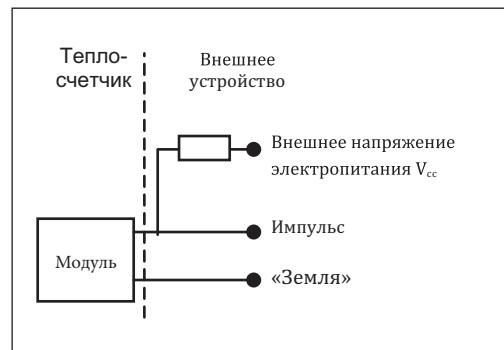
**Модуль комбинированного импульсного входа / выхода**
