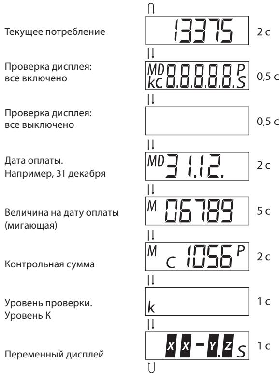
Значения символов X, Y, Z на переменном дисплее в активном режиме аналогичны значениям в «спящем» режиме. Счетчик-распределитель INDIV-5R снабжен встроенным радиопередатчиком, который обеспечивает беспроводную передачу данных в домовую радиосеть системы INDIV AMR (см. раздел «Система учета теплопотребления INDIV AMR с автоматизированным сбором и передачей показаний с распределителей INDIV-5R и других приборов учета энергоресурсов»).
