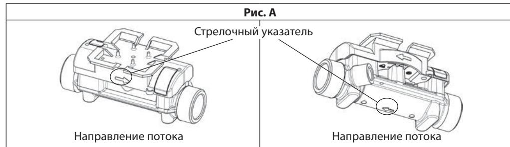
По окончании установки расходомер должен быть постоянно заполнен жидкостью. Установки элементов для гидродинамической стабилизации потока до и после расходомера (прямых участков) не требуется. Термосчетчик можно устанавливать на вертикальных или гор-
