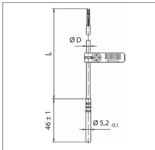
Датчик температуры (термопреобразователь сопротивления) типа Pt 500 по DIN EN 60751 используются в стандартной комплектации теплосчетчика.
