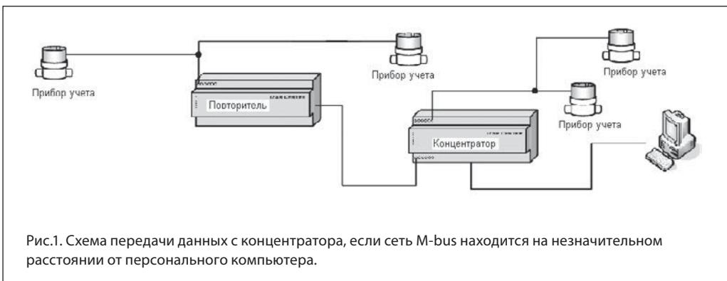
В случае, если сеть M-bus находится на удаленном расстоянии от персонального компьютера, для передачи данных с концентратора Izar Center Memory на персональный компьютер диспетчера можно использовать Ethernet-соединение либо модем для передачи данных через телефонную сеть (аналоговую (PSTN), цифровую (ISDN), беспроводную (GSM/GPRS)) (рис., с. 62).
