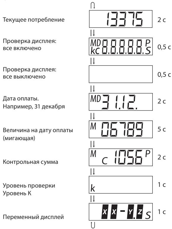
Значения символов X, Y, Z на переменном дисплее в активном режиме аналогичны значениям в «спящем режиме». Показания счетчиков-распределителей INDIV-5читываются с дисплея визуально.
