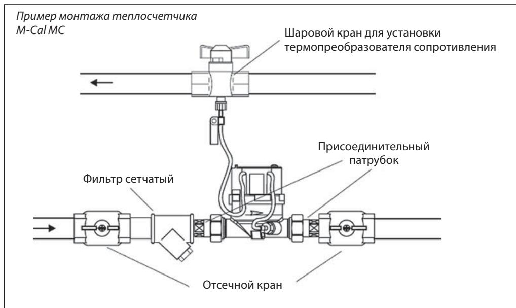
**Монтаж измерительной капсулы в проточную втулку**
