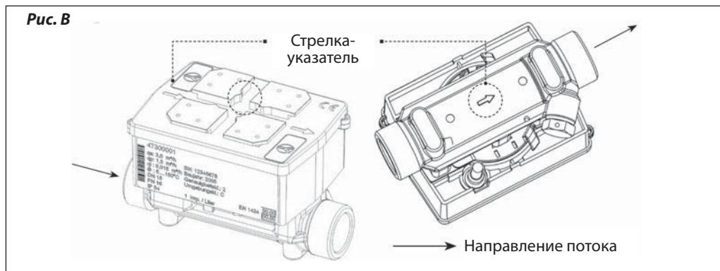
3. Установка осуществляется таким образом, чтобы расходомер был всегда полностью заполнен водой после ввода в эксплуатацию.
