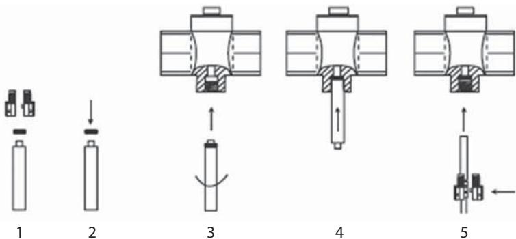
*Подключение модулей M-Bus и импульсного выхода*
