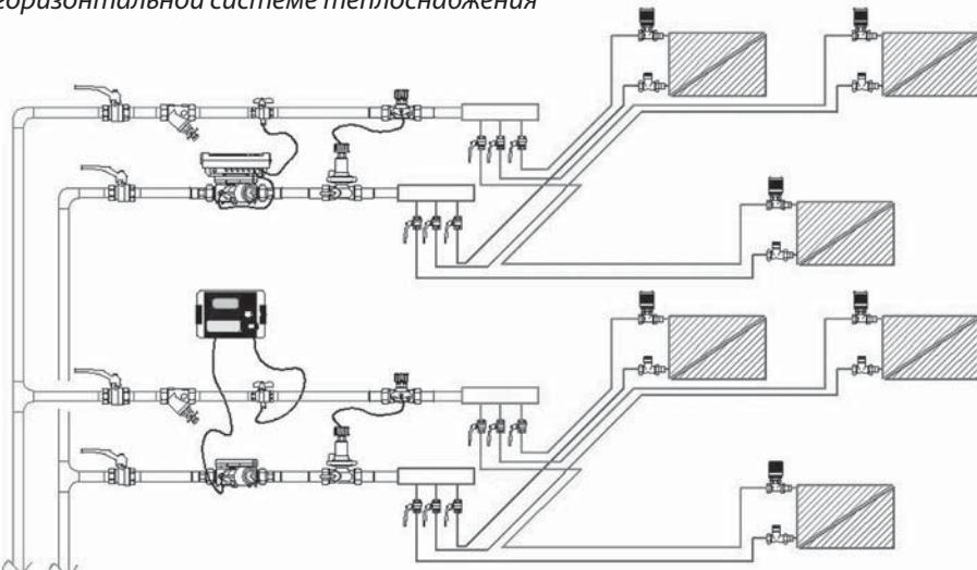
*Применение теплосчетчика Sonometer 1100 в Шкафу с узлом присоединения квартиры системы отопления (ШКСО – 1)*
