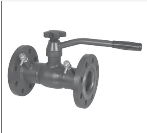
Клапан запорно-регулирующий/кран запорно-регулирующий JiP BaBV предназначен для монтажной наладки трубопроводных систем инженерного обеспечения зданий и сооружений для обеспечения в них расчетного потоко-распределения.
