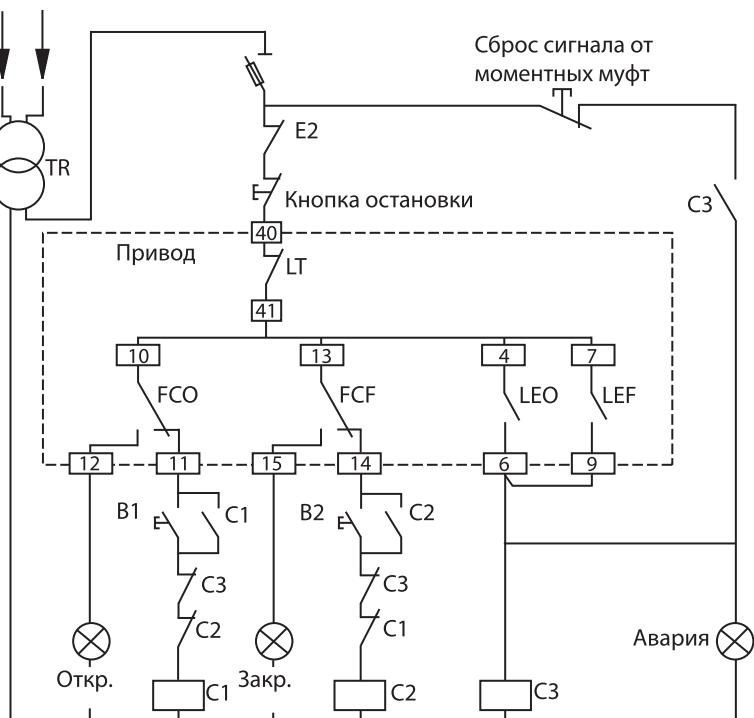
Остановка привода при полностью открытом и закрытом положении
