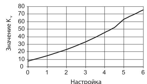
**Диаграмма для выбора типоразмера и настройки клапана (продолжение)**
