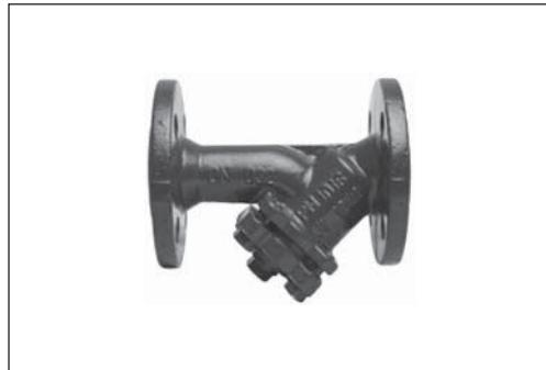
Фильтр сетчатый FVF предназначен для установки перед регулирующей арматурой, расходомерами, насосами с «мокрым» ротором электродвигателя и другими устройствами с повышенными требованиями к чистоте проходящей через них воды в системах отопления, теплоснабжения, технического горячего
