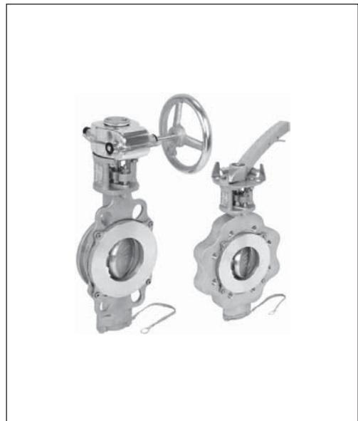
**LYCENE** ( $D_y = 32\text{--}300 \text{ мм}$ ) — дисковые поворотные затворы с корпусом из высокопрочного чугуна для химически активных сред (кислоты, щелочи, обессоленная вода) в системах водоподготовки, пищевой промышленности и т. д. Поворотные затворы LYCENE не применяются для транспортировки пара.
