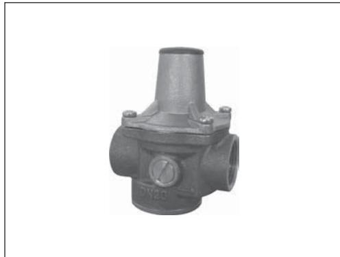
Клапаны редукционные типа 7BIS являются регуляторами давления прямого действия «после себя» и предназначены для снижения и поддержания постоянного давления на клапане вне зависимости от колебаний давления до него.
