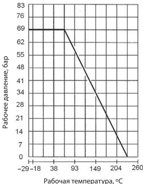
Кран шаровой стальной X3444, X3444B, X3444S, X3777, X3777B, X3777S, X3777V
