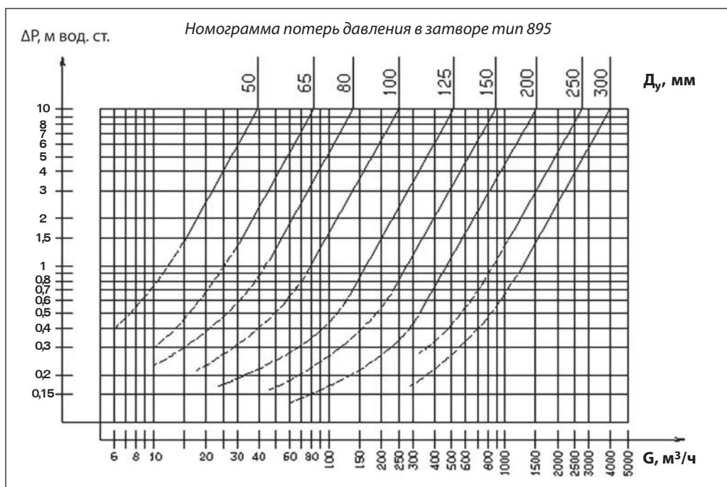
Во избежание возникновения осцилляций потока и осевых колебаний затвора следует избегать завышения диаметра трубопровода и обратного затвора, т. е. желательно, чтобы затвор не работал
