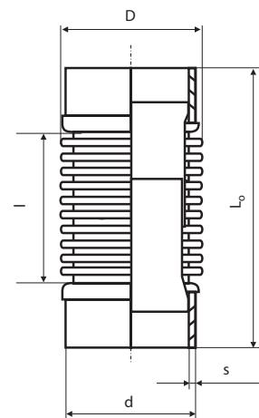
**Габаритные и присоединительные размеры, технические характеристики для расчета усилий на неподвижные опоры трубопровода (продолжение)**
