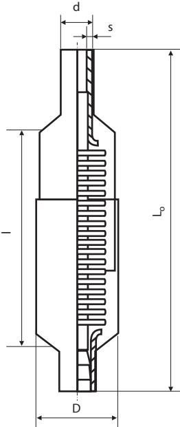
**Оевые сильфонные компенсаторы Danfoss P<sub>y</sub> 10 бар с внутренней гильзой и наружным защитным кожухом**
